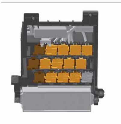
Relaisträger an der Vorderseite des Trägergehäuses – oben
