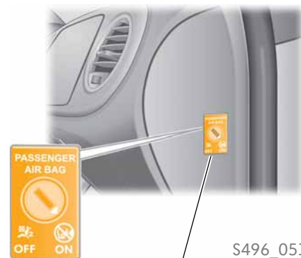
Schlüsselschalter zur Aktivierung/ Deaktivierung des Beifahrerairbags
