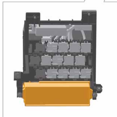
Sicherungsträger an der Vorderseite des Trägergehäuses – unten
