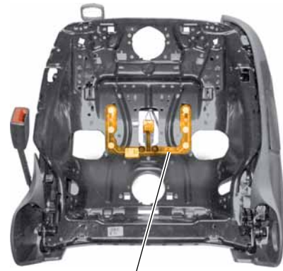
Sitzbelegungssensor Beifahrerseite G128
