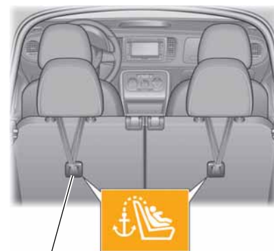
Öse zum Einhängen des Top-Tether-Gurts
