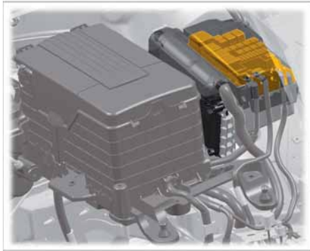
Elektrikbox im Motorraum links, neben der Batterie
